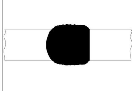
NO – resistenza sigillatura dubbia – Regolare tempo saldatura (ved.5.1)
