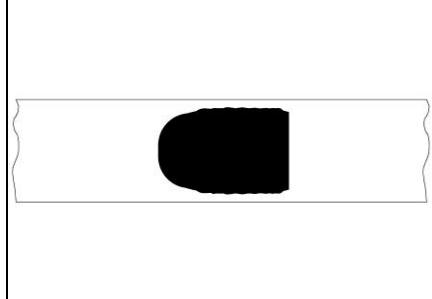
NO – resistenza sigillatura insufficiente – Regolare tempo saldatura (ved.5.1)
